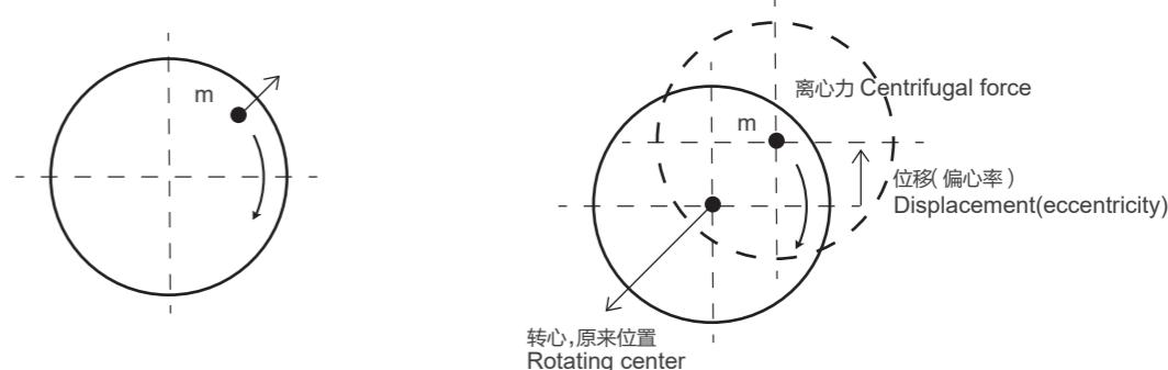
这偏心距  $e_{per}$  用下列公式表示它与圆轮重量  $m$  (kg), 半径  $R$  (mm) 及超重点  $m$  (g) 的关系:
