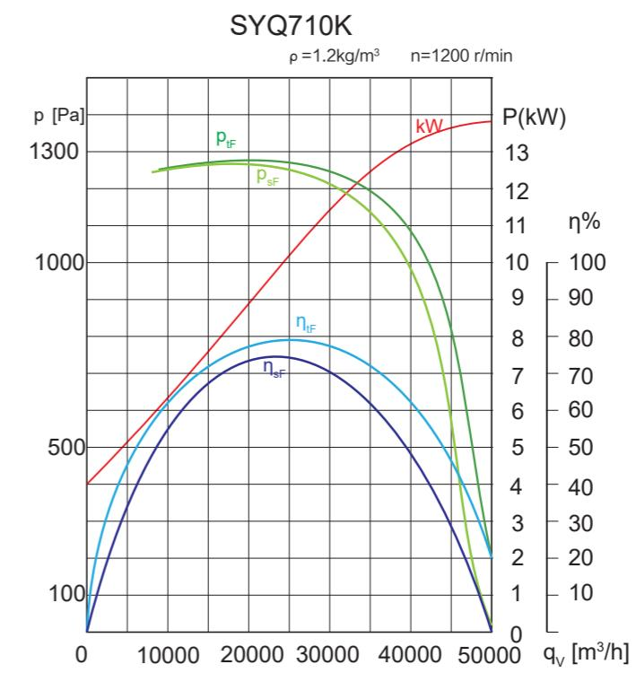
图2 风机性能曲线图
