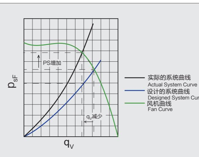
图5 系统阻力曲线的变化——风量减少
