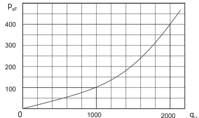
图3 系统阻力曲线
