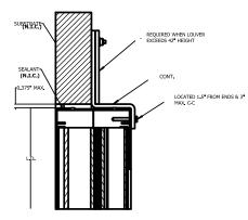
ALT. CONT. ATTACHMENT ZEE INSTALLATION @ LOUVER HEAD/SILL
