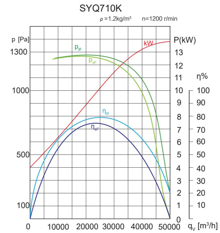
图2 风机性能曲线图
