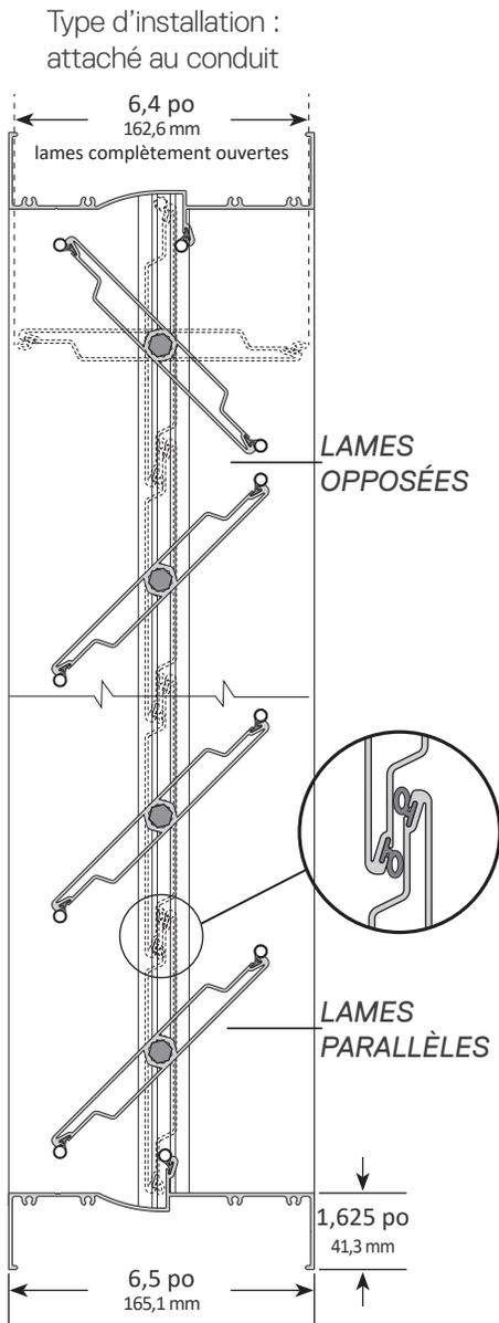
1. Le cadre est fait d'aluminium extrudé (6063-T5) d'une épaisseur minimale de 0,08 po (2,03 mm). Sa profondeur est de 6,5 po (165,1 mm), avec des brides d'assemblage de 1,625 po (41,3 mm) de largeur des deux côtés du cadre.
