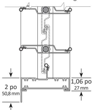
1. Le cadre est fait d'aluminium extrudé (6063-T5) d'une épaisseur minimale de 0,08 po (2,03 mm). Sa profondeur est de 4 po (101,6 mm), avec des brides d'assemblage de 1 po (25,4 mm) de largeur des deux côtés du cadre. Le cadre du volet a une bride de fixation de 2 po (50,8 mm) à l'arrière, lorsque commandé avec rebord arrière allongé.
