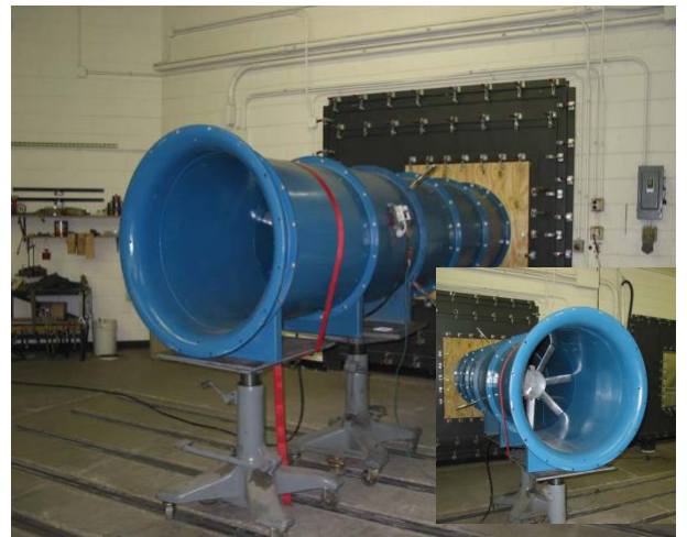
مراوح همام المحورية من طراز ADT تخضع للفحص المعمل لاختبار كميات الهواء والضغط والكفاءة والقدرة المستهلكة ومستويات الصوت بمعمل معتمد.
