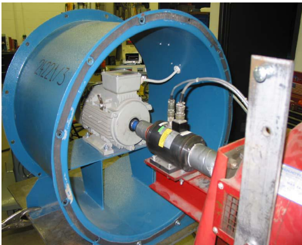
المواتير المستخدمة مع مراوح همام المحورية تخضع لاختبارات المعايرة العملية قبل فحوصات الأداء لمراوح همام المحورية من طراز ADT بمعمل معتمد.
